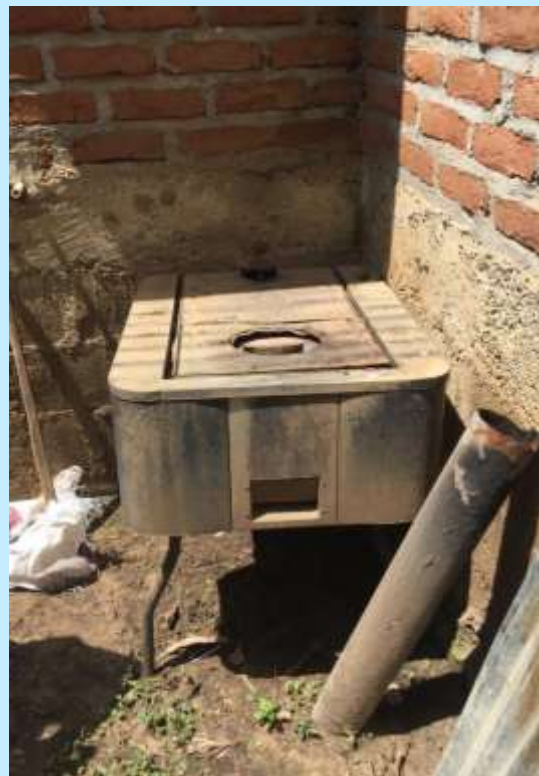
Figura 5. Estufa modelo Envirofit en desuso por deterioro.
