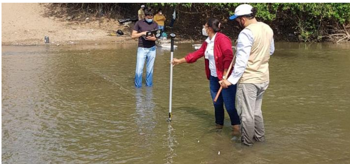
Figura 17. Aforo en la Cuenca del Río Goascorán en la época seca.
